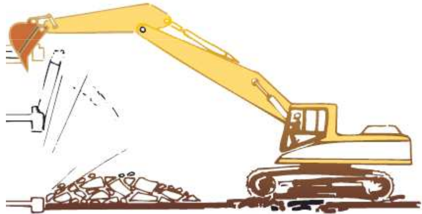
Démolition par poussée ou traction
