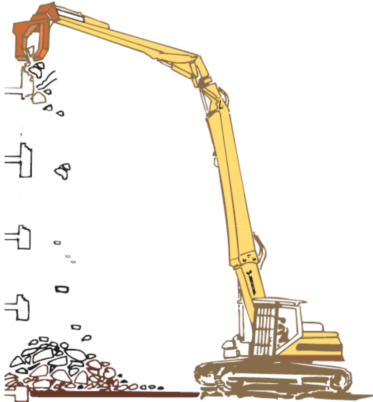
Démolition par émiettement
